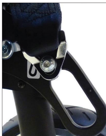
Ponto de encaixe traseiro de acordo com ISO 7176-19 para cinto
