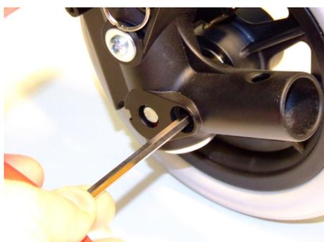
A pressão do Tensionador de rodas no orifício e, portanto, a velocidade de rolamento dos pneus, pode ser variada afrouxando ou apertando os parafusos internamente.
