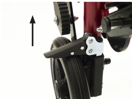
Para travar, o suporte de fixação superior deve ser abaixado na roda, pressionando até que o freio engate firmemente.
