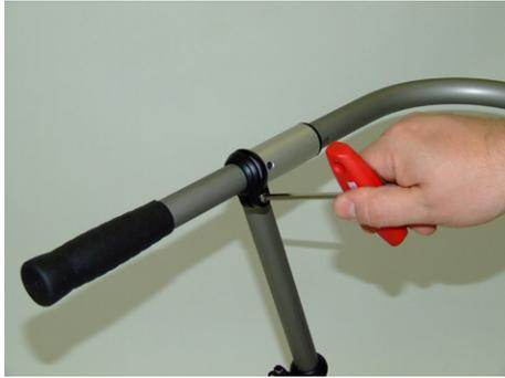
**FLUX tam. 1-3:** A profundidade da manopla deve ser ajustada de modo que a borda anterior da pega ou as almofadas do Apoio de antebraço fiquem atrás das rodas em pelo menos o comprimento de **A**. Se as Roldanas de colisão estiverem sendo usadas, a medida de **A** deve ser acrescida em um centímetro. É melhor verificar esta medida ao colocar o andador FLUX contra uma parede lisa e medir o espaço entre a parede a a manopla, ou até a almofada do Apoio de antebraço.
